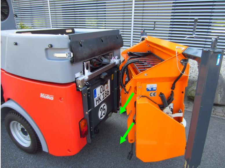
Abb. 2 Haltebolzen montiert und gesichert
