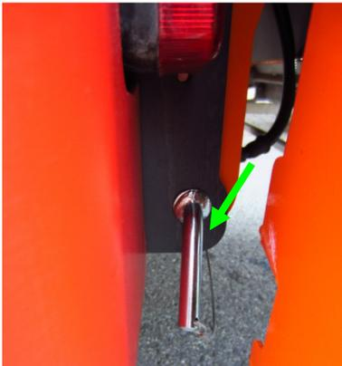
Abb. 3 Sicherungsbolzen montiert und gesichert
