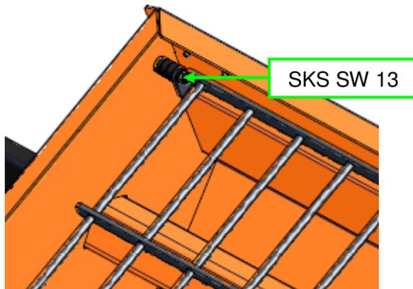
Abb. 15 Verschraubung Schutzgitter
