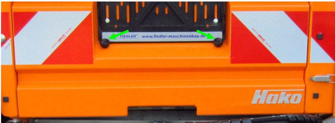
Abb. 13 Abdeckung Federspanner
